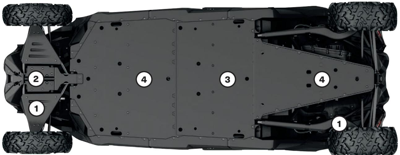
Unser Kunststoff-Unterbodenschutz gleitet ruckfrei und leise über Hindernisse und bietet dabei großartigen Schutz in rauem Gelände. Aus verschleißbeständigem, thermogeformtem hochmolekularem Polyethylen (PE-HMW) mit einer Dicke von 10 mm.
