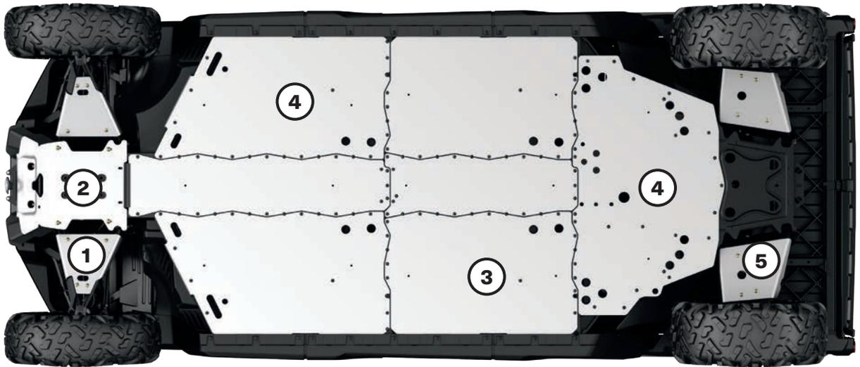
Für ultimative Beständigkeit und Robustheit ist unser gesamter Aluminium-Unterbodenschutz aus Aluminium 5052 H32 mit einer Dicke von 4,5 mm gefertigt.
